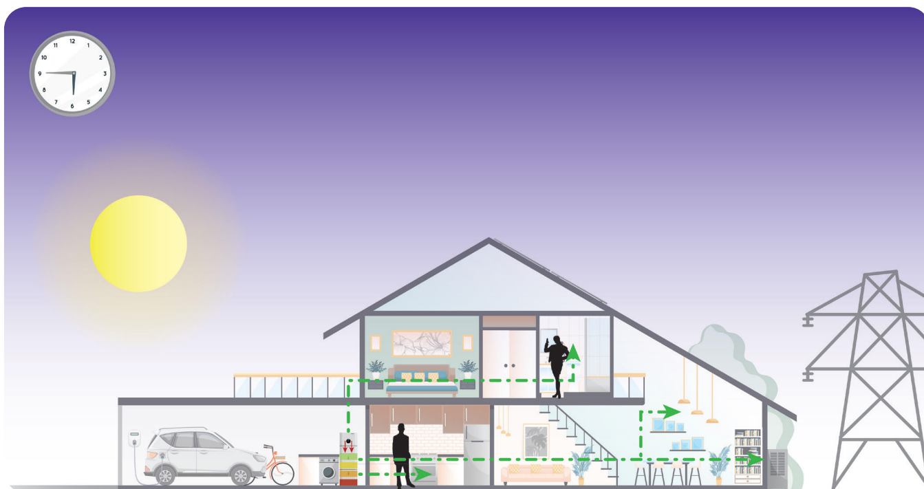
III. 7.1 - Strømmen fra nattens køb anvendes til varmepumpe og andre brugsgenstande om morgenen.
